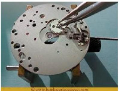
Para retirar el muelle de báscula, que está en tensión, cubrirlo con un pulidor (caprón) de piel y retirar el muelle con unas pinzas.
