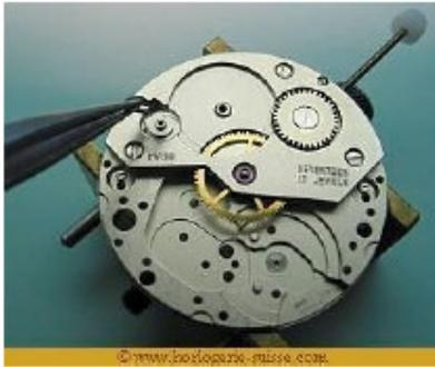
Aflobe y retire el tornillo de la rueda de corona y retire ésta, con la pequeña arandela que tiene en el centro.
