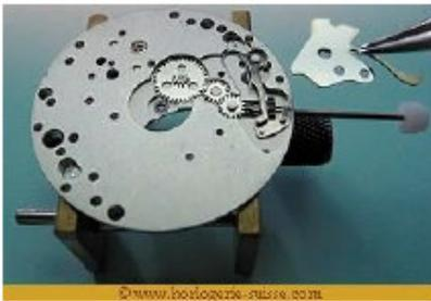
Retire las dos ruedas o piñones de transmisión y la rueda de minutería
