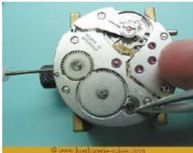
Arme el reloj suavemente con la tija de remontaje hasta llegar al tope, luego, sin soltar la tija, con unas pinzas finas de relojero, u otro objeto puntiagudo, sujete el trinquete para impedir que engrane con el rochete.
