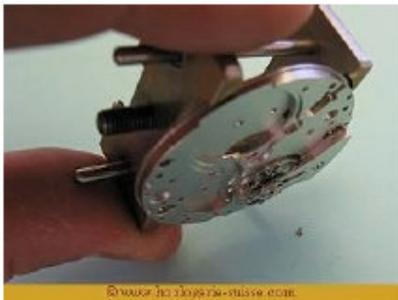
Por el lado de la esfera, retire igualmente el incabloc que corresponde al eje de volante.
