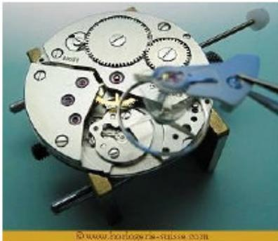
Afloje y quite los dos tornillos del puente de áncora y retire éste.
