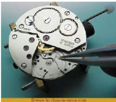
Afloje y quite los dos tornillos del puente de rodaje y retire éste levantándolo.
