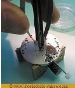
Por el lado del movimiento de nuevo, se aflojan y retiran los tres tornillos del puente del barrilete y se retira el puente.
