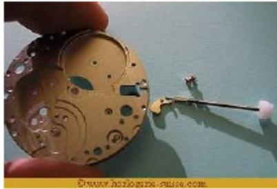
Volver a colocar en su sitio el puente de volante con éste y apretar el tornillo de sujeción. Retire el incabloc.
