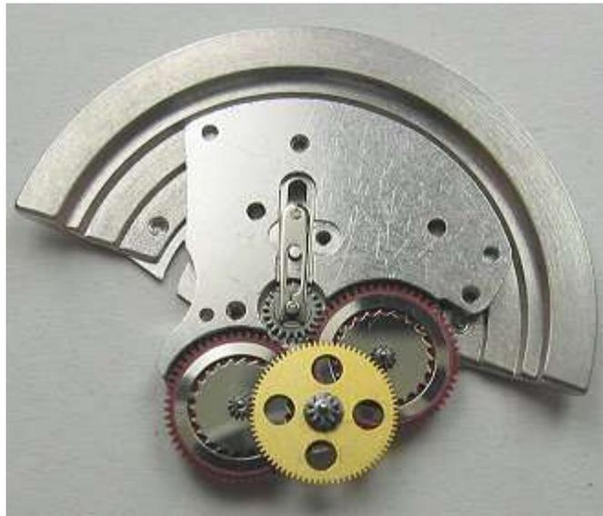
2) Le bloc sans le pont inférieur du dispositif, nous pouvons bien voir les pignon des roues d'inversion engrenés avec la roue entraîneuse de rochet ainsi que le pignon de masse oscillante et la clavette qui maintient l'axe de la masse.
